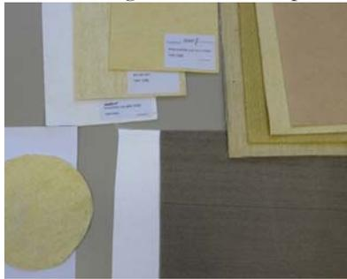
wird ein Filterhilfsmittel (Precoatmaterial) benötigt, um ein irreversibles Verstopfen der eingesetzten Filterschläuche zu verhindern und die Abscheidung der Feinstaubpartikeln zu gewährleisten. Der Filter ist hinsichtlich Druckverlustverlauf, Filterfläche, Abreinigungsdruck, Abscheidegrad, Trenngrad und Precoatmaterial in der Vergangenheit durch verschiedene experimentelle Untersuchungen bereits charakterisiert worden.
